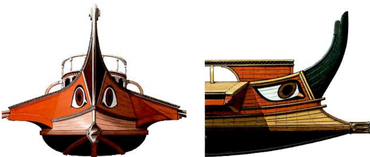
RICOSTRUZIONE DELLA PRUA DI UNA QUINQUEREME ROMANA. VISTA DI FRONTE E VISTA DI PROFILO
