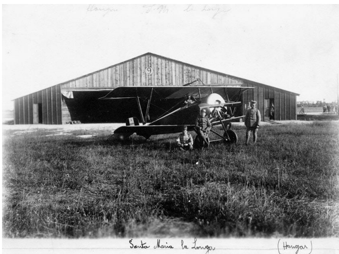
FIGURA 58 – NIEUPOINT NI.11 "BEBÈ" DELLA 76ª SQUADRIGLIA SUL CAMPO DI VOLO DI SANTA MARIA LA LONGA
