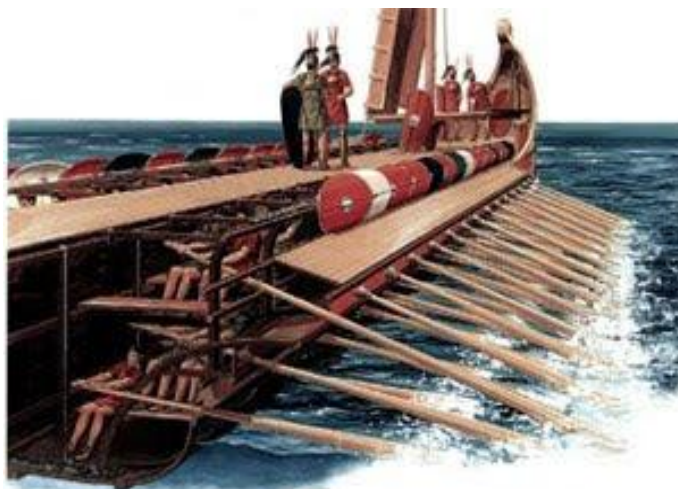
POSSIBILE SISTEMAZIONE DEI REMATORI A BORDO DI UNA QUINQUEREME
