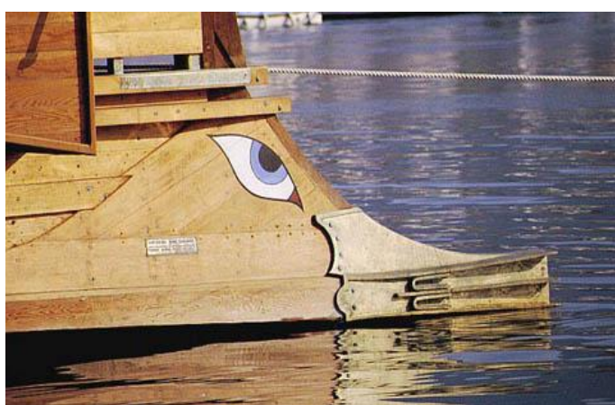
LA PRUA DELLA OLYMPIÀS. EVIDENTI IL ROSTRO IN BRONZO E LE TESTE DEI NUMEROSI CHIODI DELLO STESSO METALLO
